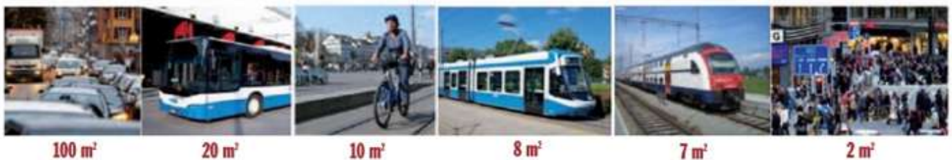
Figure 45 l'efficacité des différents modes de transport selon la surface occupée par personne
